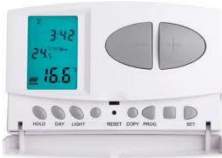
Za svaki dan u nedelji se mogu podesiti temperaturni programi koji su nezavisni jedni od drugih. Može se podesiti 6 termina (**P1-P6**) za uključenje po slobodnom izboru (u desetominutnim sekvencama), a uz svaki termin uključenja mogu se podesiti temperature (u sekvencama po  $0.5^{\circ}\text{C}$ ) a postoji i jedan fiksni program (**P0**) za svaki dan.
