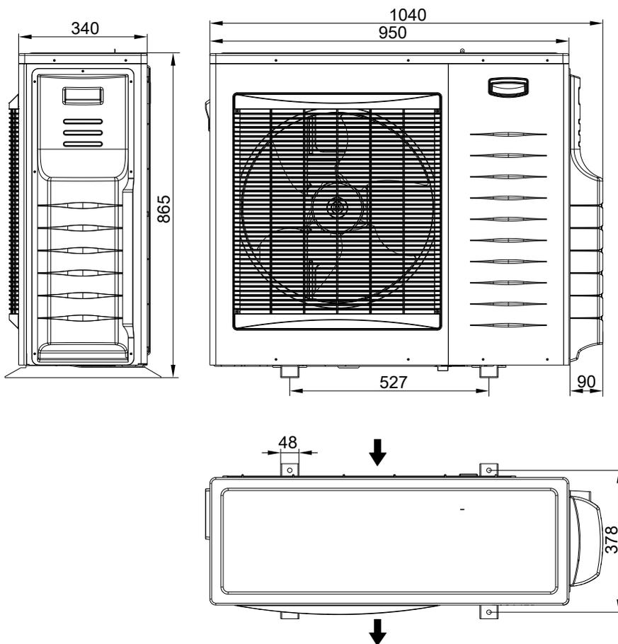
Außeneinheit 10 kW, 13 kW und 16 kW, 230 V und 400 V
