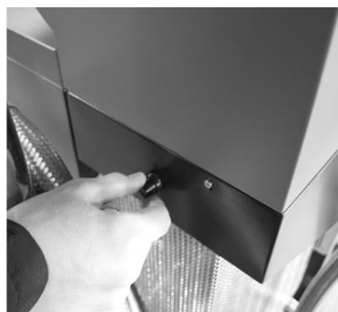
Slika 23: Aktiviranje termične sigurnosti- STB
